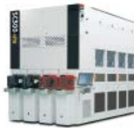
枚葉式リン酸エッチング装置
