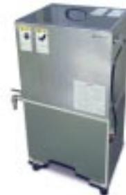
工作機械用切削液浄化システム
